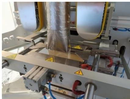
**Unità di saldatura orizzontale**
